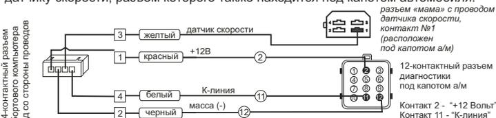
!!! На а/м "Газель", "Соболь", выпускаемых с 2002 г., на контакт "2" колодки поступает напряжение после замка зажигания.
