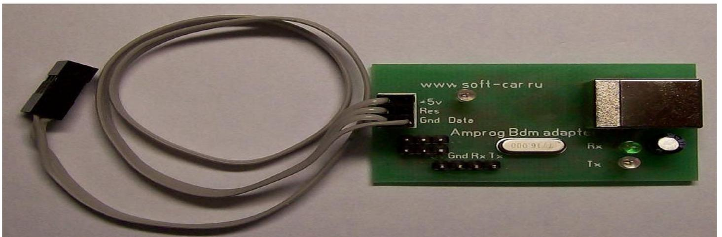
Подключение к Ампрог , выбор в меню "АП без 0 16 вив " Адаптер подключаем к панели через кабель согласно рисунку
