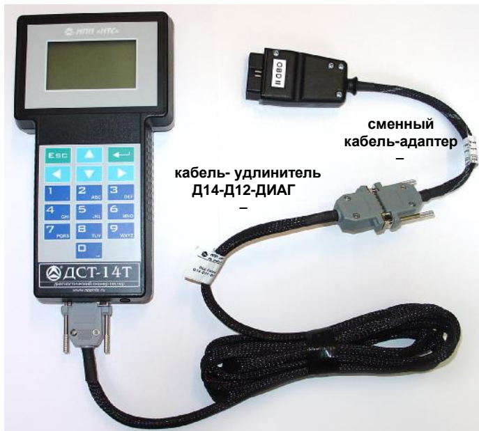
Рис. 2. Подключение кабелей к сканеру тестеру
