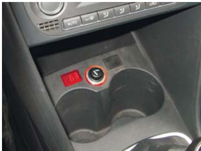
Рисунок 1. Цифровой индикатор температуры.
