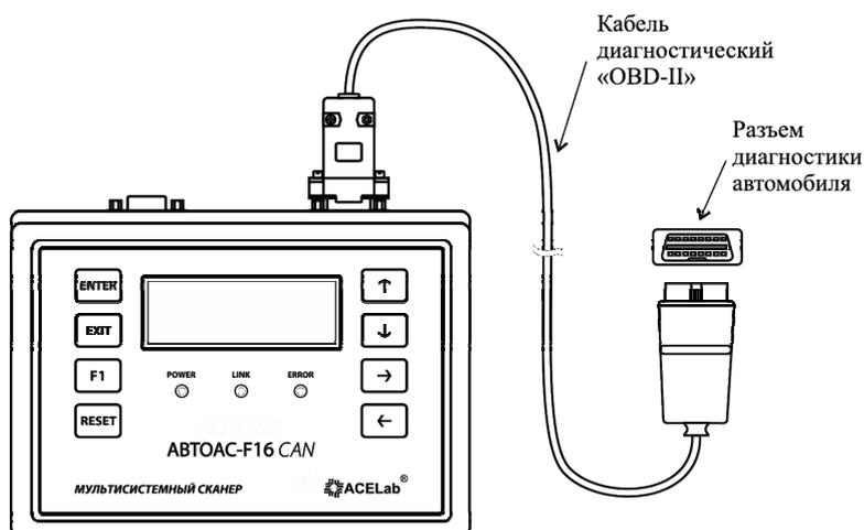
Рис. 4. Подключение прибора к автомобилю DAEWOO с 16-ти контактным разъемом диагностики OBD-II.
