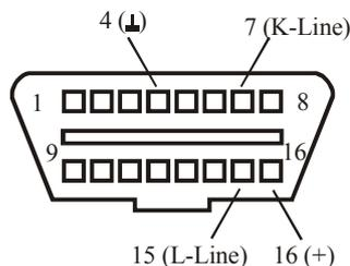
Рис. 2. 16-ти контактный диагностический разъем OBD-II.
