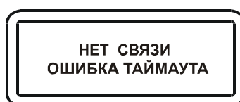
Рис. 5. Нет связи между прибором и ЭБУ.
