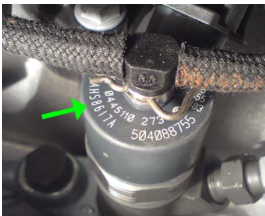
Фото 1. ИМА-код электромагнитной форсунки.
