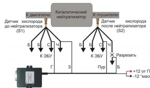
При этом вход, входную и выходную массы незадействованного канала, следует подключить к массе авто. Для второго канала это фиолетовый, черный и коричневые провода.
