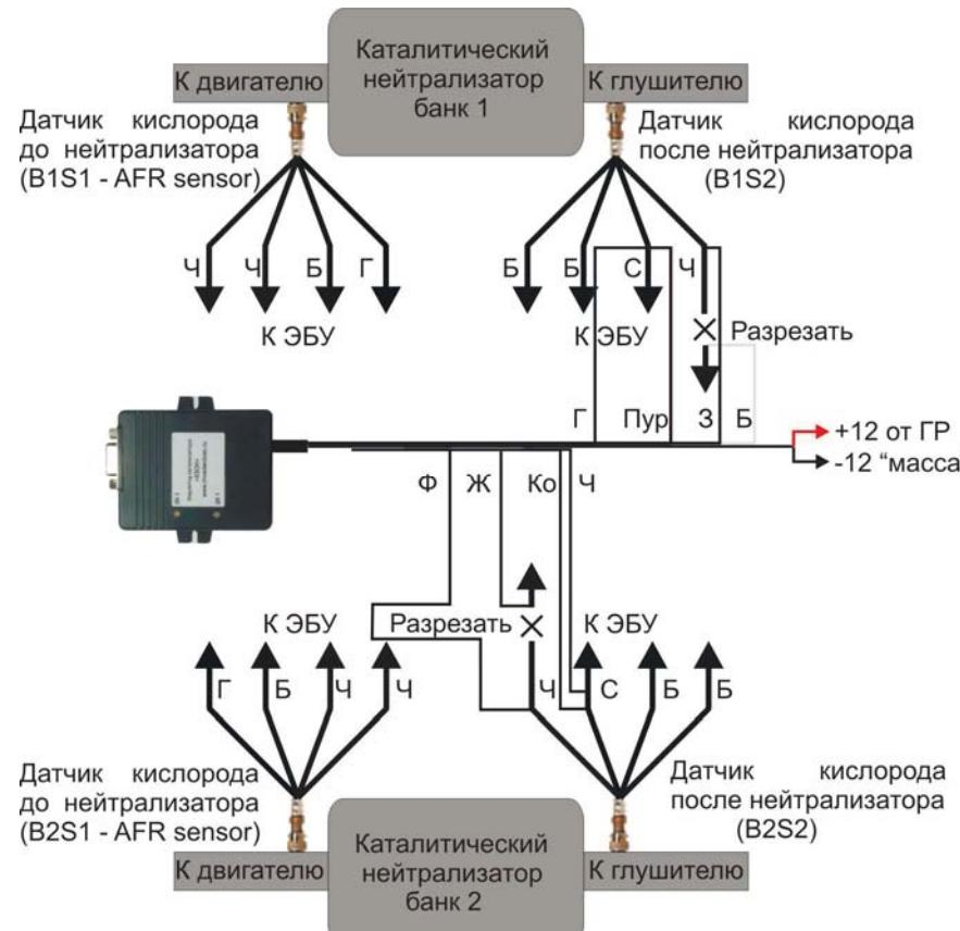
Эта схема включения, предназначена для подключения к системам управления двигателем, имеющим передний широкополосный, четырехвыводной датчик состава смеси (AFRS). Для полноценного функционирования данной схемы, **обязательно требуется рабочий задний датчик кислорода**, который должен быть **помещен (оставлен после удаления катализатора) в поток выхлопных газов**.
