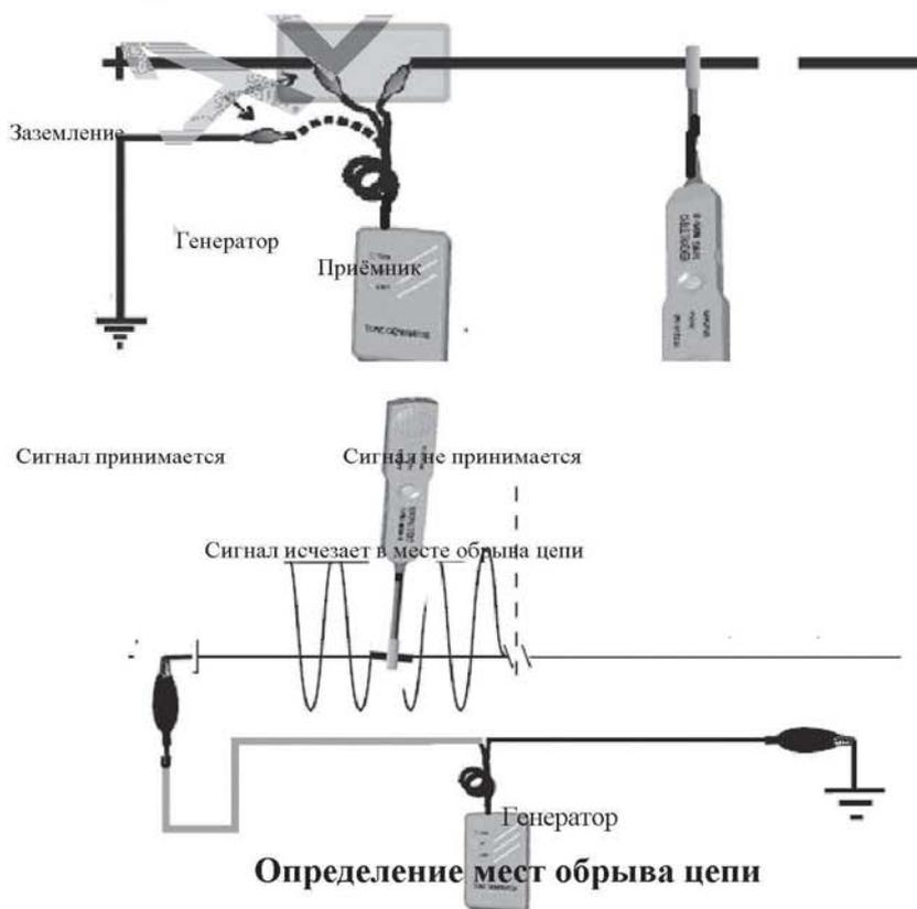
2.2 Подсоедините генератор FF310T последовательно к проблемному проводу; при этом один из зажимов генератора подсоединяется к положительному концу цепи или к заземлению. Возможные точки подключения: гнездо для предохранителя (предохранитель должен быть удалён), соединитель, и т.п. (см. рисунок выше).
