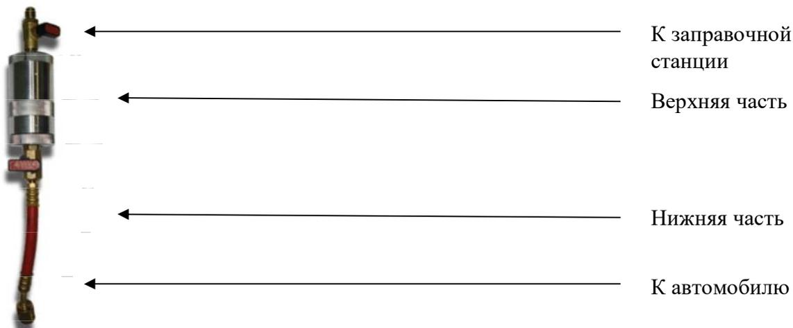
Если при заправке систем кондиционирования требуется заправить или дозаправить систему маслом, в этом случае возможно использование заправочного цилиндра (приобретается отдельно). Подсоединение заправочного цилиндра возможно к любому из шлангов до процедуры вакуумирования системы кондиционирования. Заправку масла лучше производить через линию низкого давления. Для этого необходимо:
